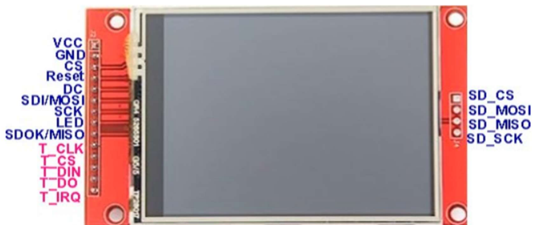
Figuur 3: 2,4 inch TFT-kleurenschermmodule pinout [5]
